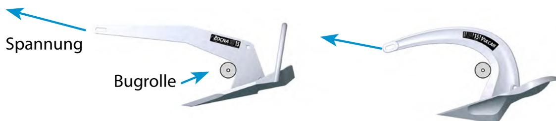
Es ist ideal, wenn Ihr Anker während der Fahrt mit einem Seil festgezurt wird. Der Rocna verfügt über einen Zurrpunkt und die Befestigung des Tandemankers kann sowohl für Rocna, als auch Vulcan verwendet werden. Bei den größeren Modellen raten wir davon ab, dieses Loch für Rückhalteriegel oder -stifte zu verwenden, denn wenn eine Welle den Anker erwischt während Sie auf See sind, kann der Riegel verbiegen und
