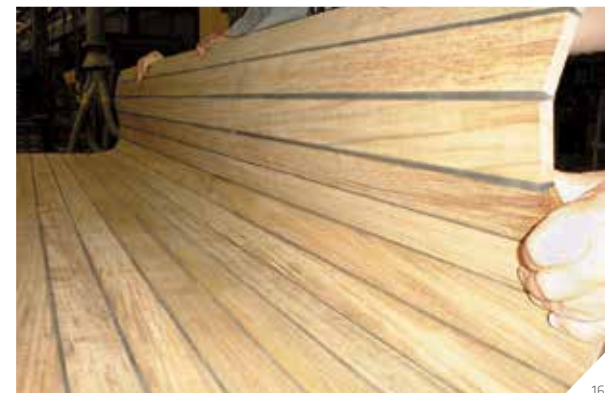
Abb. 16: Vorgefertigtes Teakdeck aus Stabdeckleisten mit beachtlicher Festigkeit und Elastizität
