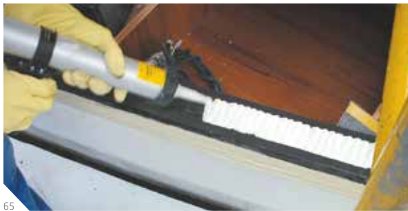
Abb. 64: Sikaflex®-292i wird dickschichtig auf die Verbindungsfläche aufgetragen: Am Bug ... Abb. 65: ... und entlang der Seiten
