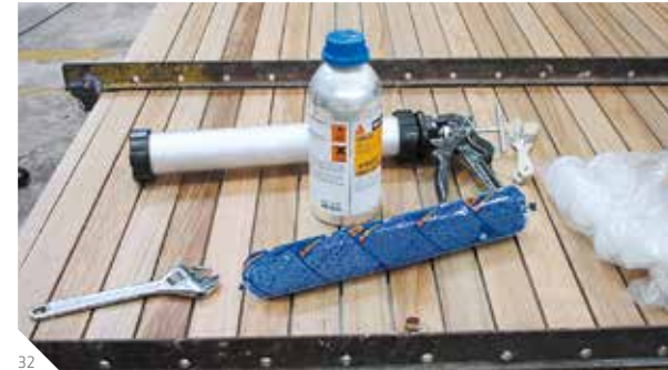
Abb. 32: Stabdeck zur Aushärtung eingespannt
