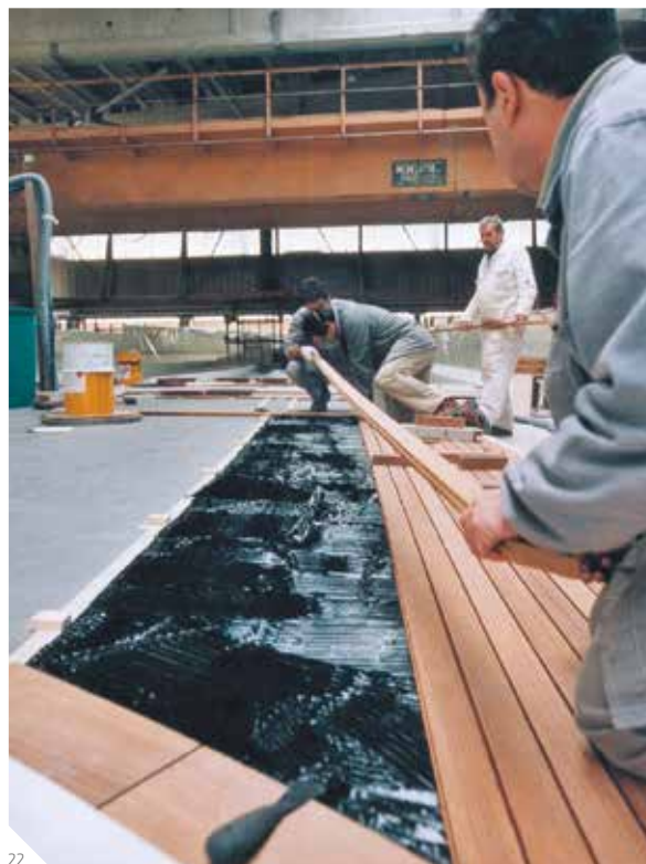
Abb. 22: Aufbringen des Decks
