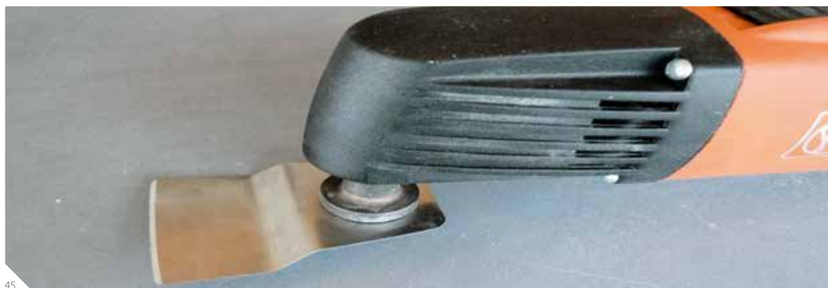
Abb. 44: Zuerst altes Klebebett mit einem Schaber entfernen
