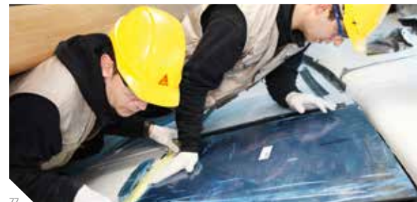
Abb. 77: Auftrag von Sikaflex®-296
