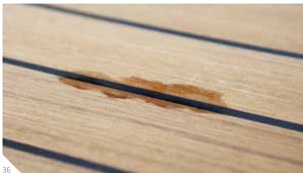
Abb. 36: Beschädigtes Teakdeck durch Wassereintrich
