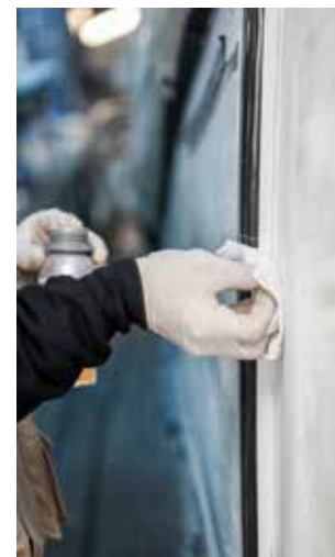
Abb. 81: Vorbehandlung des Keramiksiebdruckrands mit Sika Aktivator-100
