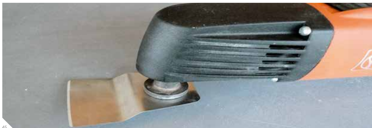
Abb. 44: Zuerst altes Klebebett mit einem Schaber entfernen
