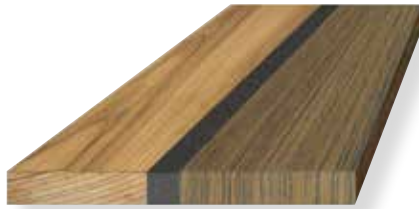
Abb. 24: Links liegende Jahresringe (nicht empfohlen), rechts stehende Jahresringe (empfohlen)
