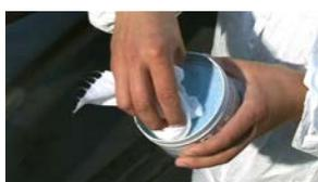
Zur Langzeitkonservierung des Gelcoats wird zu guter Letzt BOAT WAX (oder ähnlich geeignete Versiegelungen wie z.B. REFINISH PREMIUM GLOSS) verwendet, um die Fläche vor UV-Licht zu schützen und unempfindlicher gegen Verschmutzung zu machen. Das Wachs wird dünn mit einem Lappen aufgetragen. Nach einer Abluftzeit von ca. 20 Minuten wird die Fläche mit einem fussselfreiem Lappen manuell auf Hochglanz poliert. Nach 2 Stunden kann ggf. ein zweiter Wachsauftrag vorgenommen werden.
