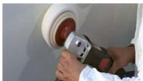
Für ein hochglänzendes Endergebnis verwendet man die Schleif- und Polierpaste REFINISH (grob). Die Polierpaste wird gleichmäßig auf die zu polierende Fläche aufgetragen und mit der Hand oder besser mit einer Poliermaschine und dem POLISHING PAD (Schaumteller) aufpoliert. Die Poliermaschine sollte maximal eine Umdrehung von 1400 U/Min. aufweisen, um durch die Wärmeentwicklung das Gelcoat nicht zu beschädigen.
