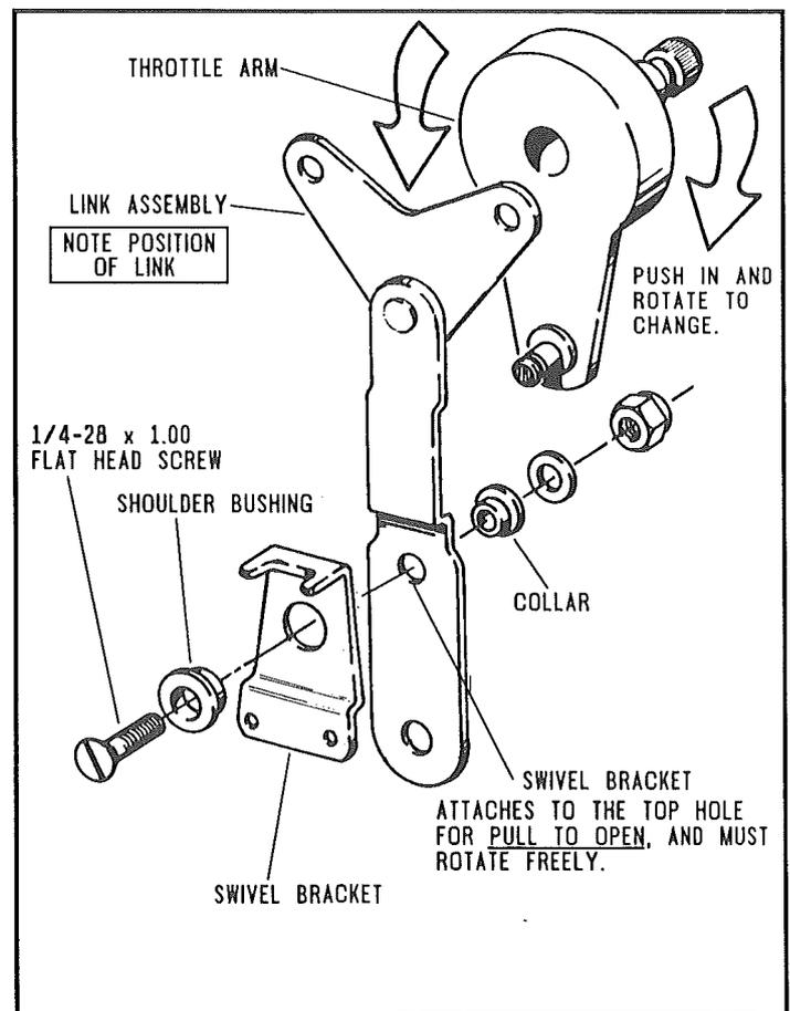
FIGURE 5 PULL-TO-OPEN CONFIGURATION
