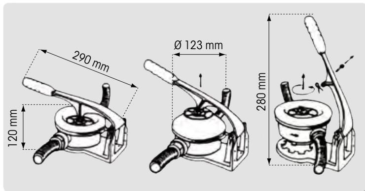
Interventionen sind sehr leicht durchzuführen, indem Sie den Hebel von der Membran trennen, anschliessend den Rumpf der Pumpe mit einer Viertelumdrehung lösen. Bei der Montage berücksichtigen Sie bitte den Rückschlag, Hebel in aufrechter Position (siehe Skizze).
