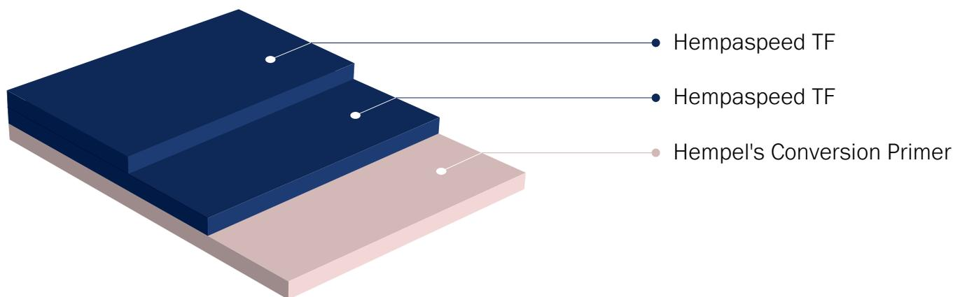
Für einen ganzjährigen Schutz – muss die alte Beschichtung nicht entfernt werden. Lediglich eine Schicht von Hempel's Conversion Primer, ist vor dem Auftragen von zwei Schichten Hempaspeed TF erforderlich.
