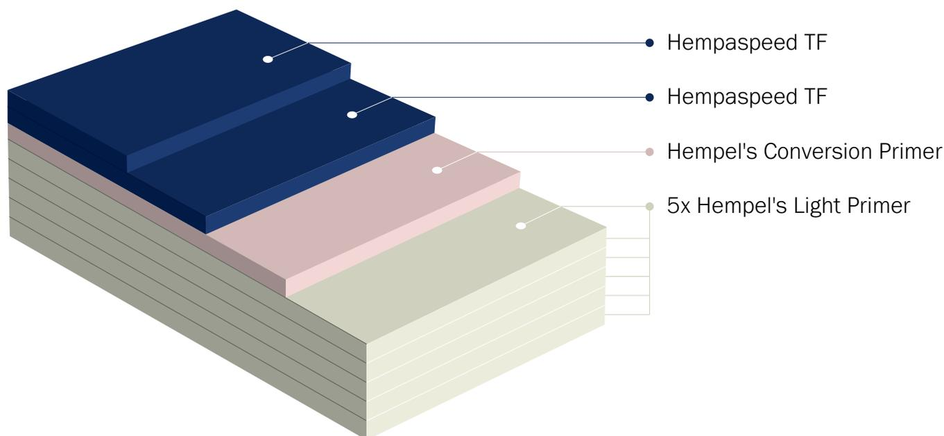
Für einen ganzjährigen Schutz muss der Untergrund mit Hempel's Light Primer (300 µm dft) versiegelt werden, bevor Hempel's Conversion Primer und zwei Anstriche Hempaspeed TF aufgetragen werden. Befolgen Sie die angegebenen Überstreichintervalle, zwischen der Grundierung und dem Produkt, um Zwischenschichthaftung zu gewährleisten.
