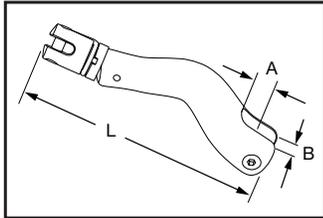
Die spezielle Formgebung bewirkt die selbstständige Ausrichtung des Ankers beim Hieven und sorgt für eine gute Anpassung an die Ankerrolle, leichtgängiger Kugelkopfwirbel, das innovative Schnellwechselsystem ermöglicht einen einfachen Ankerwechsel.
