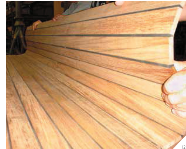
Abb. 12: Vorgefertigtes Teakdeck aus Stabdeckleisten mit beachtlicher Festigkeit und Elastizität
