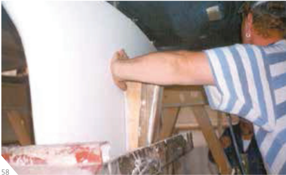
Abb. 58: Den Kiel vorsichtig in die gewünschte Position schieben
