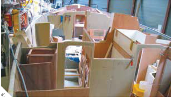
Abb. 49: Leichtbauplatten werden an einen offenen Schiffsrumpf angebracht
