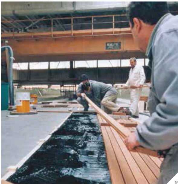
Abb. 16: Aufbringen des Decks
