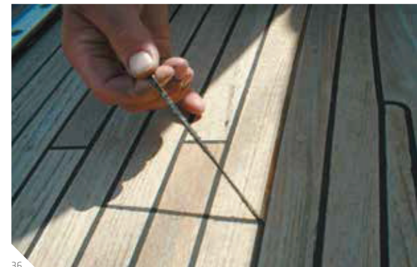
Abb. 36: Ausgeschnittene dreieckige Raupe des alten Fugenmaterials wird von Hand aus der Fuge gezogen
