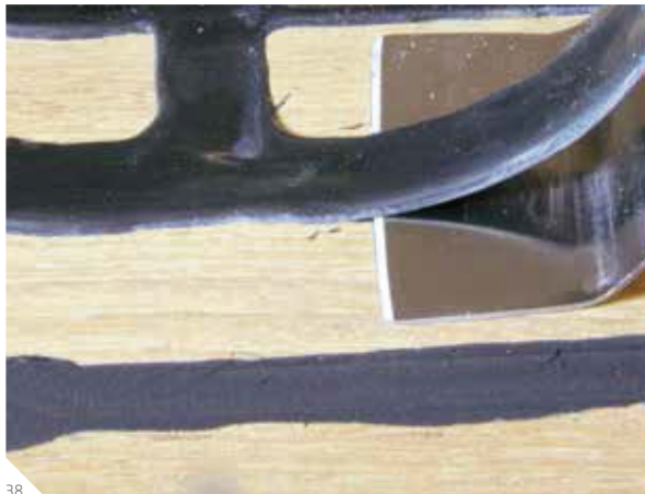
Abb. 37: Trennen der Leisten mit einer Vibrationssäge
