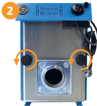
2 Um den Maritime Booster® zu reinigen, müssen diese beiden Schrauben entfernt werden.
